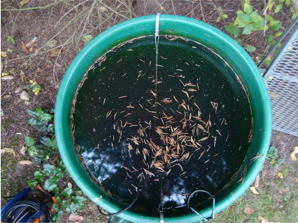
**Bild 13** Potenzialwirbel durch Anregung von der „Mini-Wava“. Die Öffnung letzterer ist tief in der Mitte erkennbar
